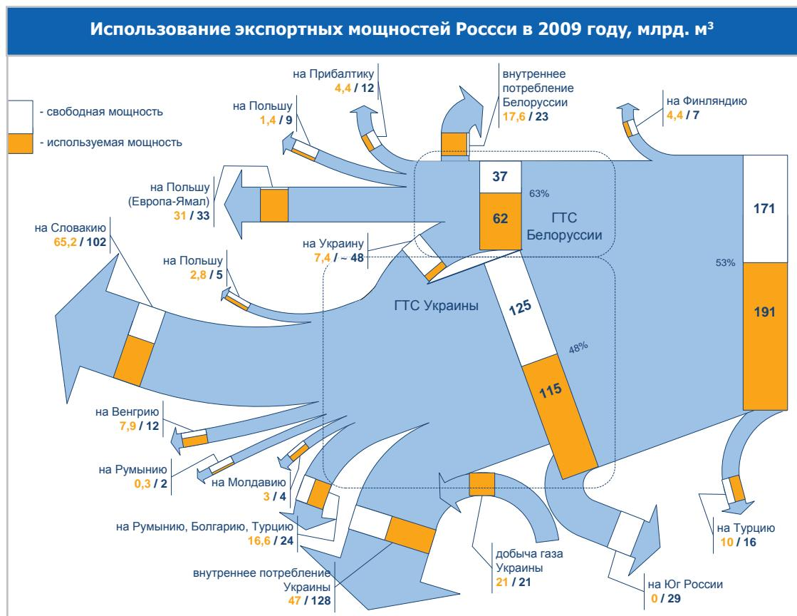
Даже беглый взгляд на карту газовой промышленности России выделяет четыре экспортных направления, по которым газ транспортируется из России. Это газопроводы в сторону Финляндии, Турции («Голубой поток») и две газотранспортные системы транзитных стран - Украины и Белоруссии.
